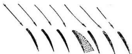
Рис. 4.16. Схема течения воздуха в компрессорной решетке при наличии срывной зоны
