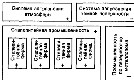
Рис. 13.2. Субоптимизация на сталелитейном комплексе (знаками «плюс» и «минус» указаны положительные и отрицательные стороны перехода на кислородное дутье).
