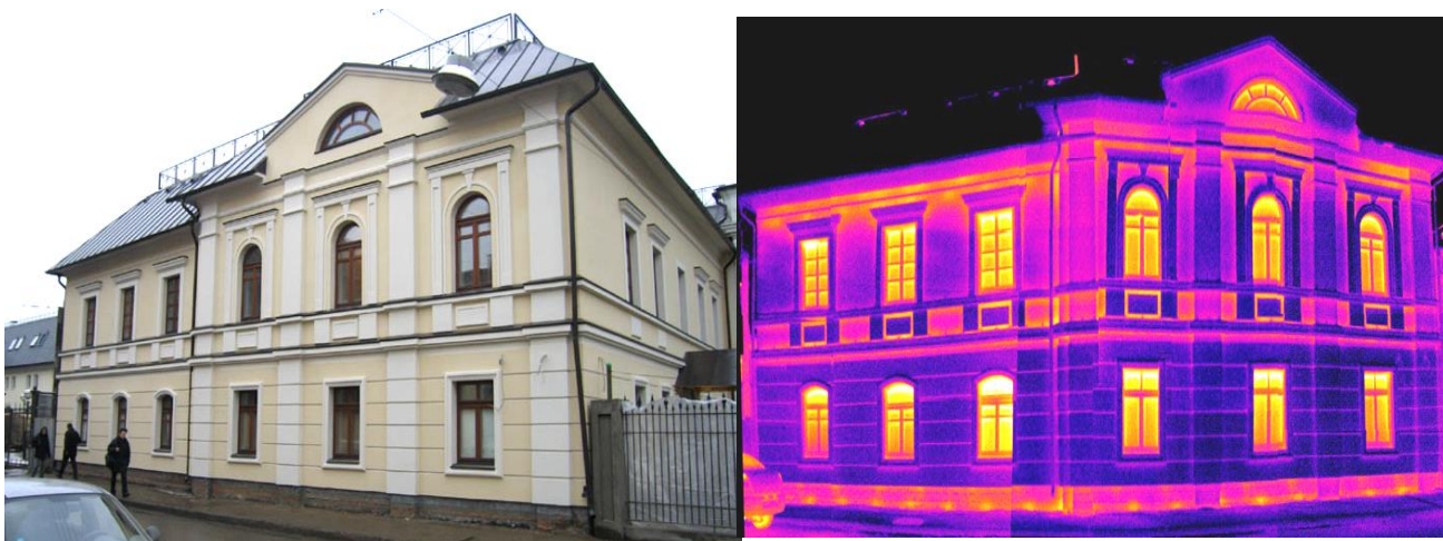
Рис. 2.7. Тепловизионное обследование здания III группы капитальности
