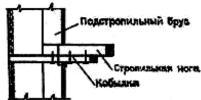
Детали деревянных стропил: а- крепление схватки к стропильной ноге; б- коньковый узел; в- карнизный узел; г и д- опирание стоек и подкосов
