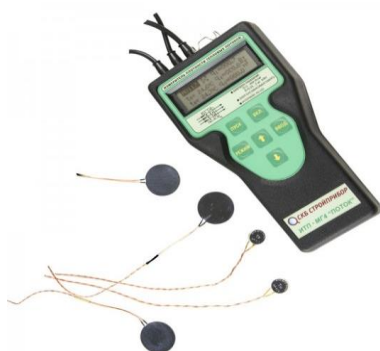
Рис. 2.6. Измеритель плотности тепловых потоков ИТП-МГ4 «Поток» предназначен для измерения плотности тепловых потоков по ГОСТ 25380-82, проходящих через ограждающие конструкции, а также для определения сопротивления ограждающих конструкций.
