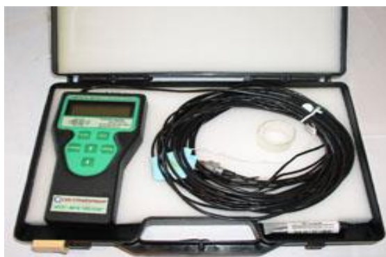
Рис. 2.6. Измеритель плотности тепловых потоков ИТП-МГ4 «Поток» предназначен для измерения плотности тепловых потоков по ГОСТ 25380-82, проходящих через ограждающие конструкции, а также для определения сопротивления ограждающих конструкций.
