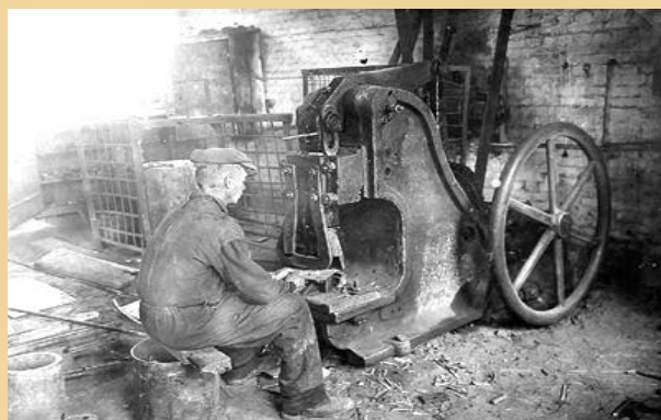
Резка кирпичных пластин на резательном станке. 1948 г.
