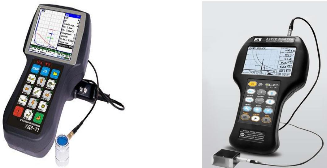
Рис. 3.15. Ультразвуковые дефектоскопы отечественного УДЗ-71 и Спектр
