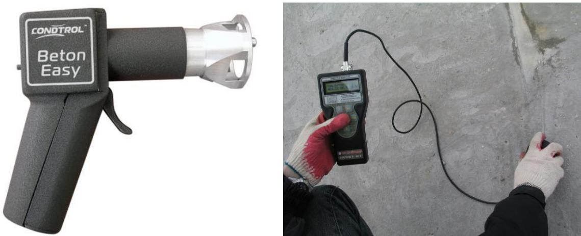
Рис. 3.16. Измерители прочности бетона фирмы Beton Easy и Склерометр
