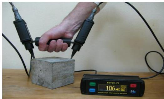
Индикатор прочности бетона "Бетон-70" предназначен для измерения времени распространения ультразвуковых колебаний (УЗК) в строительных материалах при экспрессных определениях прочности бетона в сборных и монолитных бетонных и железобетонных изделиях и конструкциях.
