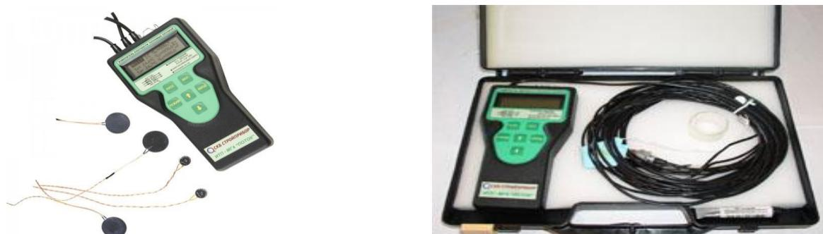
Рис. 3.28. Измеритель плотности тепловых потоков ИТП-МГ4 «Поток» предназначен для измерения плотности тепловых потоков по ГОСТ 25380-82, проходящих через ограждающие конструкции, а также для определения сопротивления ограждающих конструкций.
