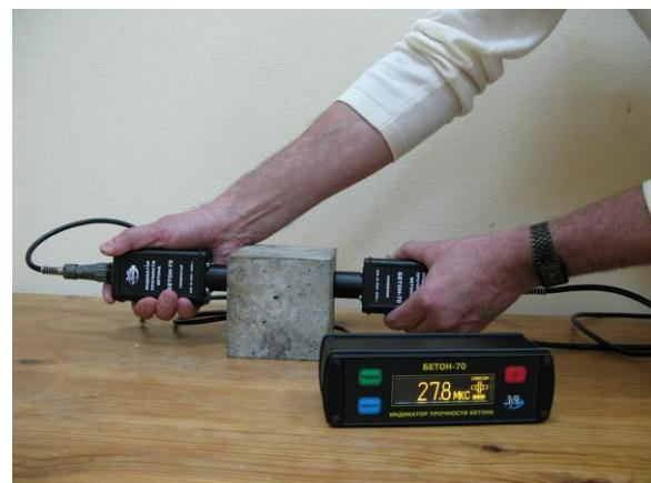
Рис. 3.14. Способы ультразвукового прозвучивания бетона
