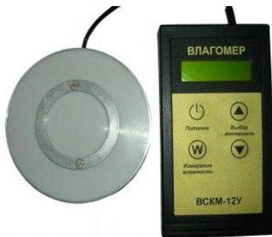
Измерение влажности непосредственно на объекте в настоящее время производят при помощи электронного влагомера ВСКМ-12 или других дизелькометрических влагомеров, отвечающих требованиям ГОСТ 21718-84.
