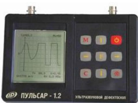
**Ультразвуковой дефектоскоп ПУЛЬСАР-1.2** предназначен для дефектоскопии и контроля прочности изделий и конструкций из бетона, кирпича и других материалов (ГОСТ 17624, ГОСТ 24322).
