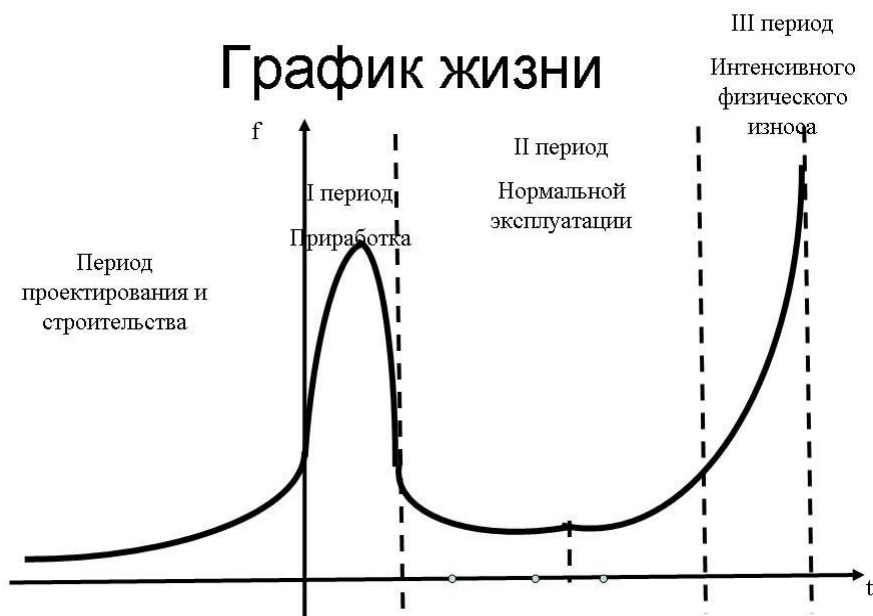
Рис. 1.3. График «жизни» сооружений всех типов капитальности в пределах нормативного срока эксплуатации: граница периода интенсивного физического износа - нормативная долговечность сооружения
