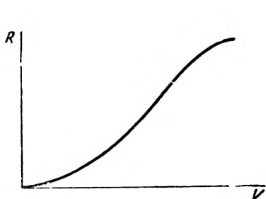
Рис. 4. Характер изменения силы тяги прямоточного воздушно-реактивного двигателя в зависимости от скорости полета
