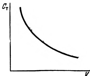
Рис. 23. Изменение удельного расхода топлива C_t ракетного двигателя твердого топлива в зависимости от скорости полета
