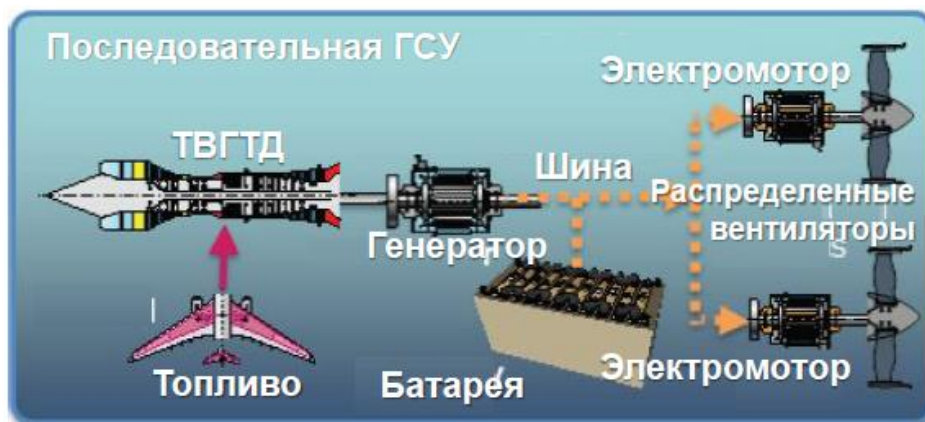
Рис. 7.3. Принципиальная схема последовательной ГСУ
