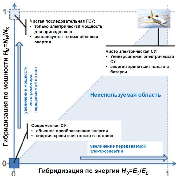
Рис. 1.17. Степень гибридизации ГСУ по мощности и энергии
