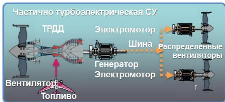
Рис. 7.6. Принципиальная схема частично ТЭСУ
