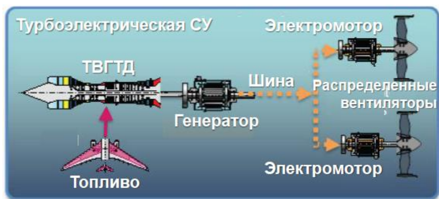
Рис. 7.2. Принципиальная схема «чистой» последовательной ГСУ или ТэСУ
