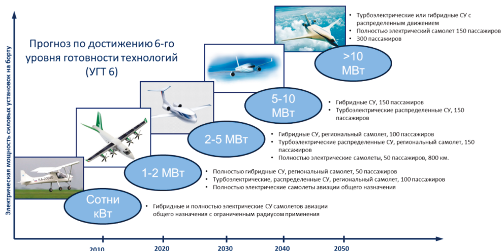
Рис. 1.18. Подход NASA по созданию гибридных и электрических СУ для летательных аппаратов различного назначения
