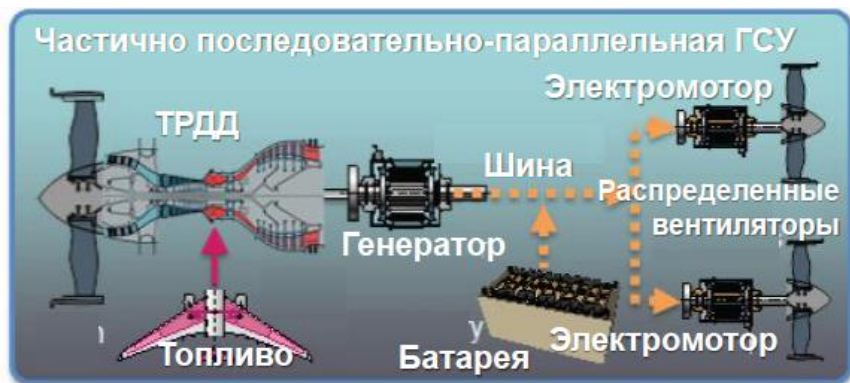
Рис. 7.5. Принципиальная схема последовательно-параллельной ГСУ
