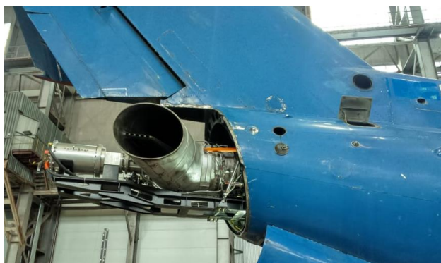
Рис. 7.14. Размещения электрического генератора и его привода на базе ТВ2-117 в хвостовой части самолета
