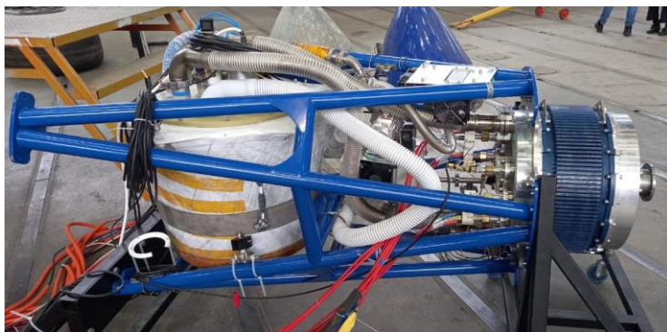
Рис. 7.12. ВТСП электрический двигатель и его криосистема, смонтированные на мотораме
