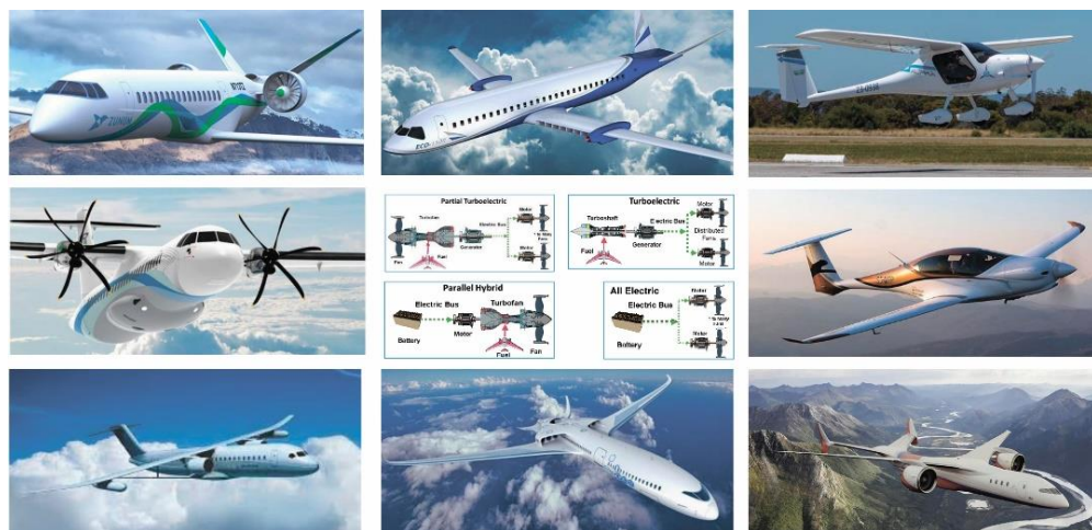
Рис. 1.21. Аэродинамические схемы пассажирских самолетов с гибридными и электрическими силовыми установками
