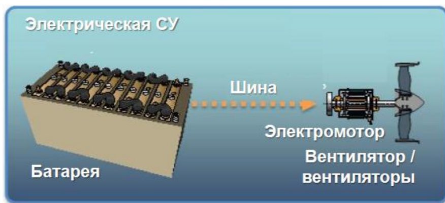
Рис. 7.1. Принципиальная схема электрической СУ
