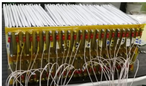
Рис. 7.10. Блок литий-ионных аккумуляторных батарей
