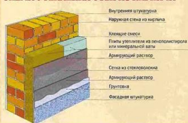
СХЕМА УТЕПЛЕНИЯ СТЕН ИЗ КИРПИЧА
