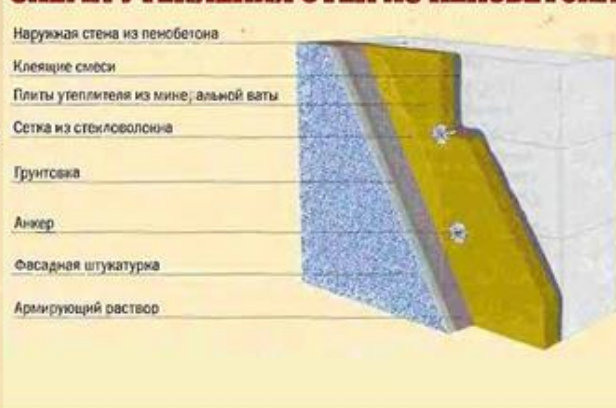
СХЕМА УТЕПЛЕНИЯ СТЕН ИЗ ПЕНОБЕТОНА
